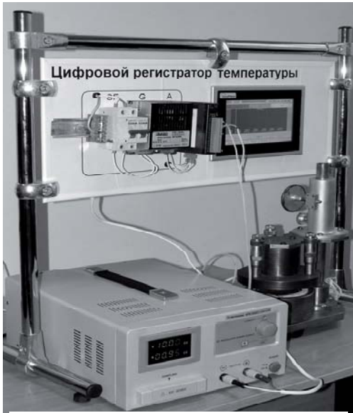
Рис. 1. Внешний вид автоматизированного измерительного стенда для оценки теплозащитных свойств материалов
